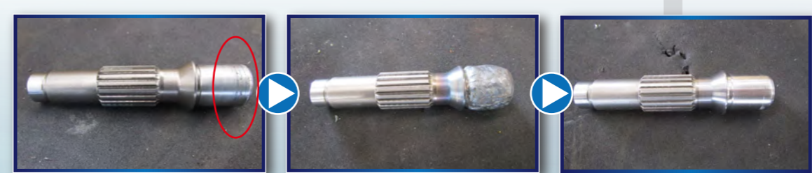
ボールベアリングが圧入される箇所に腐食があり、油漏れ
