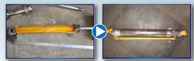
治具を作製して分解 ネジ部のカジリでネジ山潰れ
