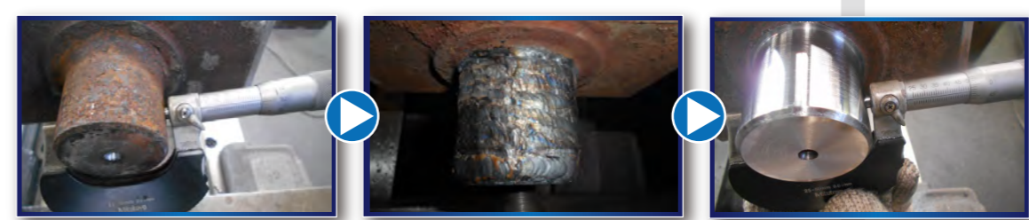
錆腐食によって表面粗さ、寸法不良
