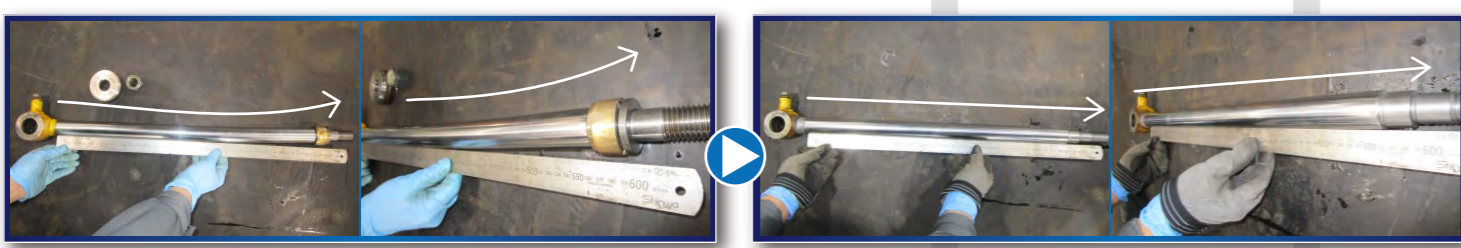
ロッドの中間付近から曲がり
